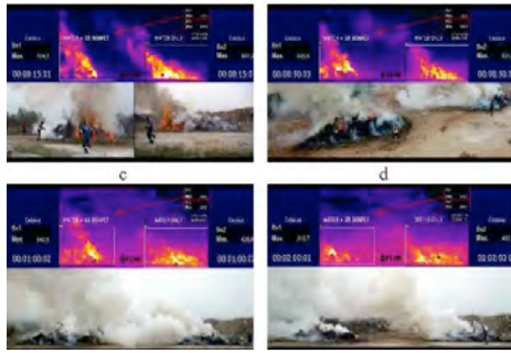
Obr. 4 Vizuálny vývoj oboch požiarov zachytený optickou a termovíznou kamerou po 15s (vľavo hore), 30s (vpravo hore), 60s (vľavo dole) a 120s (vpravo dole) od zahájenia hasenia, na každom obrázku je hasenie s vodnou zmesou BONPET vľavo, pričom hasenie s bežnou vodou napravo.
